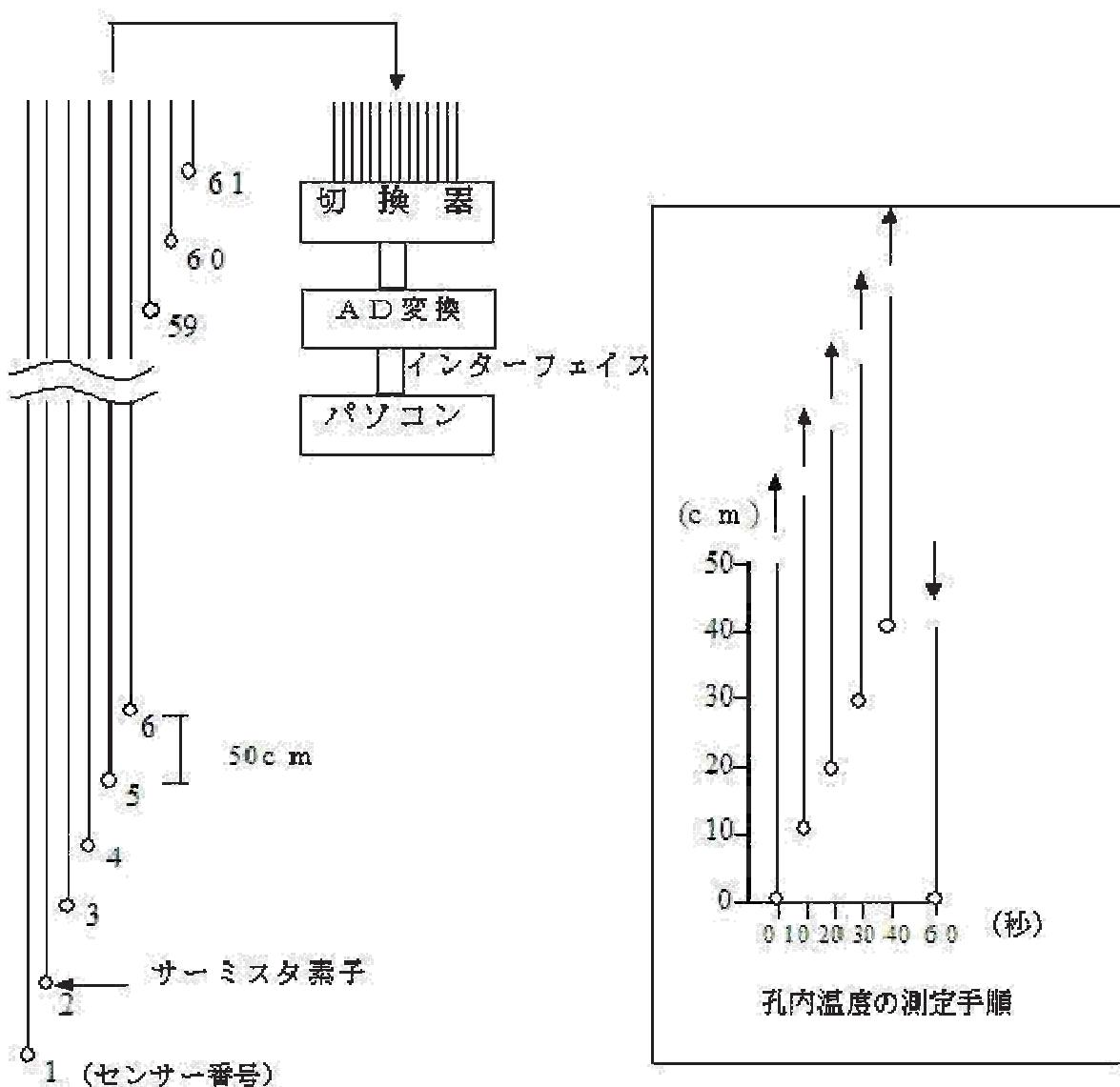
図2-3 プローブの構造と測定手順
